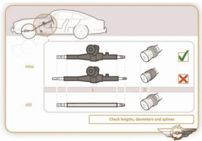
Dans l'industrie automobile, il est courant d'avoir de petites tolérances dans les connexions de cannelures. Dans des cas très exceptionnels, la connexion d'un nouvel arbre de l'unité EZ dans le joint en U d'origine (ancien) peut entraîner un ajustement serré. Ce problème est parfois relativement facile à résoudre en ne ponçant que 0,2 mm (0,007 pouce) dans la partie intérieure du joint en U et également dans la cannelure de l'arbre de sortie de l'unité EZ.
