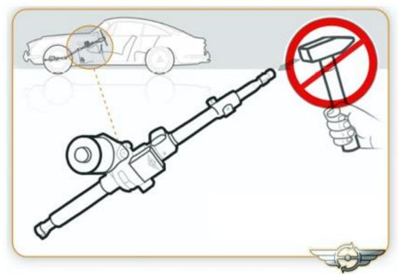
Ne frappez jamais l'arbre d'entrée avec un objet pendant ou après le montage. Cela pourrait nuire aux capteurs.
