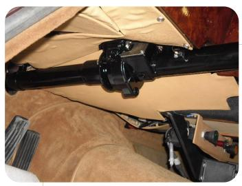
Étape 22. Montez le couvercle au-dessous de tableau de bord et ajustez-le s'il faut.
