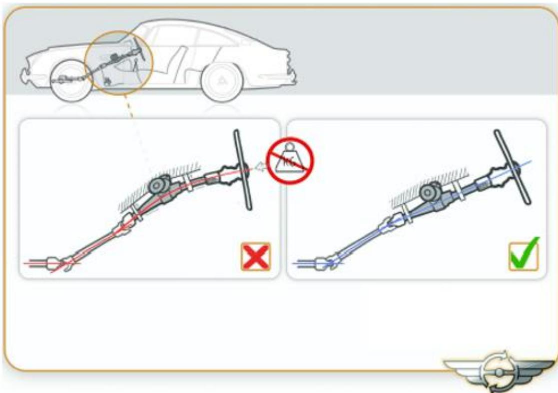
Le système de direction doit toujours être correctement aligné et monté sans tension.
